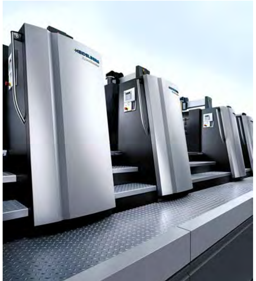
Die einzelnen Druckwerke sind von allen Seiten gut zugänglich und einzeln steuerbar
